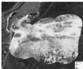
Figura 6. Estimació del gruix de neu a l'estació de Grandvalira mitjançant dron i LiDAR (10/02/2020). Font: AR+
