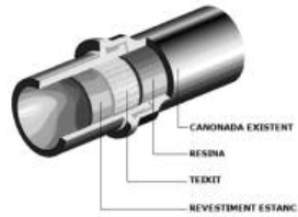
Figura 1. Esquema de les parts d'una canonada rehabilitada per CIPP
