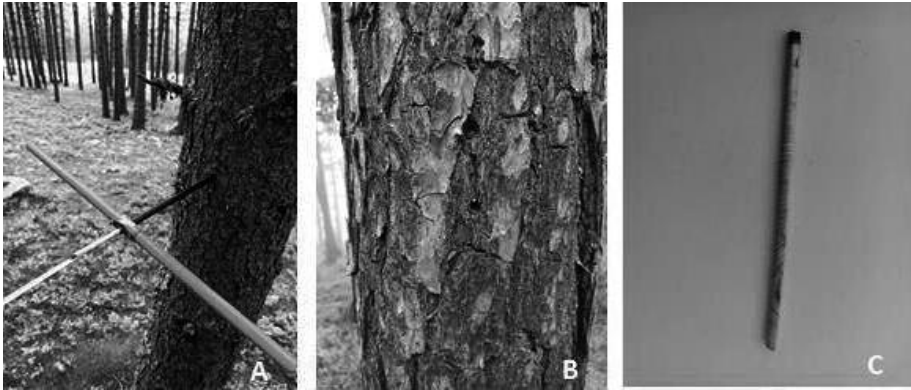
Figura 5. A: barra de Pressler extraient un core d'un pi negre. B: Forats residuals deguts a l'extracció dels dos cores. C: core de pi roig abans de ser encolat al llistó de fusta
